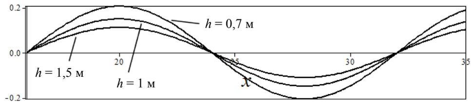
Рис. 4. Форма свободной поверхности при разной глубине расположения цилиндра ( $c = 5$  м/с,  $a = 0,5$  м)
