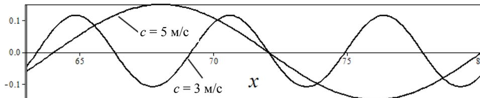
Рис. 3. Форма свободной поверхности при разной скорости потока ( $a = 0,5$  м,  $h = 1$  м)
