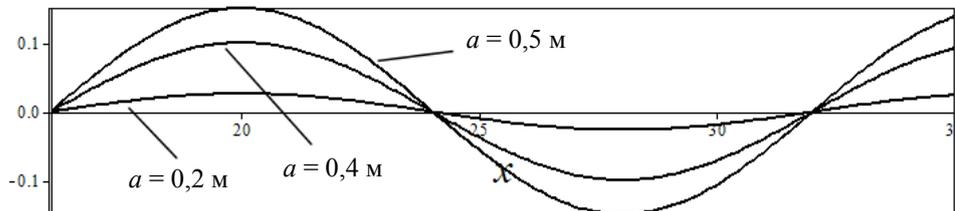
Рис. 2. Форма свободной поверхности при разном радиусе цилиндра ( $c = 5$  м/с,  $h = 1$  м)
